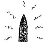
DIE OXIDSCHICHT AUF DER SPITZE FUNKTIONIERT WIE EIN ISOLATOR GEGEN HITZE. WIR SOLLTEN ALSO DIE SPITZE VON DIESER SCHICHT BEFREIEN BEVOR WIR LÖTEN WOLLEN, DAMIT DIE HITZE BESSER FLIEßT UND WIR SOMIT EINE GUTE LÖTVERBINDUNG HERSTELLEN KÖNNEN.
