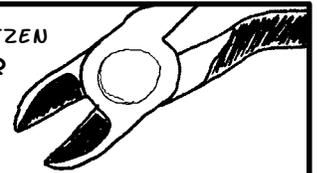
SETZE DEN SEITENSCHNEIDER MIT DER FLACHEN SEITE NACH UNTEN DIREKT ÜBER DER SPITZE DES LÖTZINNHÜGELS AM DRAHT AN UND DRÜCK DIE GRIFFE ZUSAMMEN UM DEN DRAHT ZU TRENNEN.
